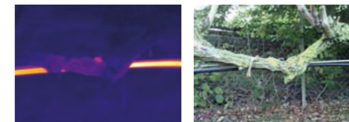
Image thermographique du câble en situation
